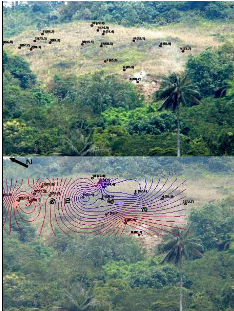
Figura 1.39. Mapa de isotermas en el campo fumarólico principal del VCM. Los círculos rellenos representan los sitios donde se realizaron las mediciones. Los contornos representan valores de iso temperatura. La flecha representa el norte.
